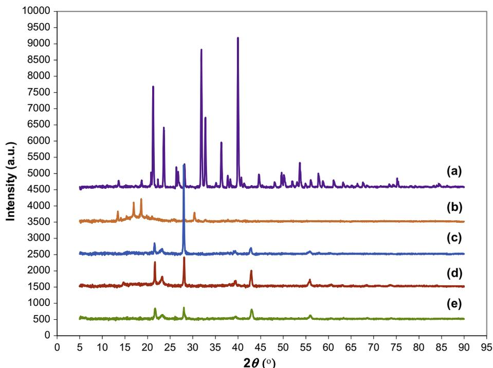
Fig. 9. XRD pattern of (a) pure  $\text{LiBF}_4$ , (b) pure PAA, (c) P80-L20, (d) P75-L25, and (e) P70-L30.
